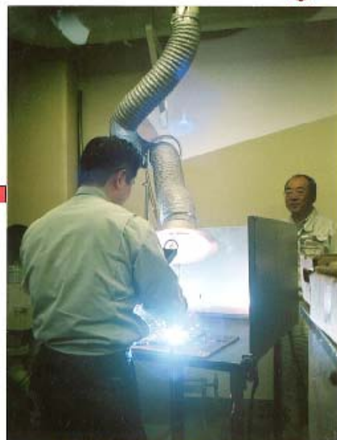
(2) 集塵機の作動開始
